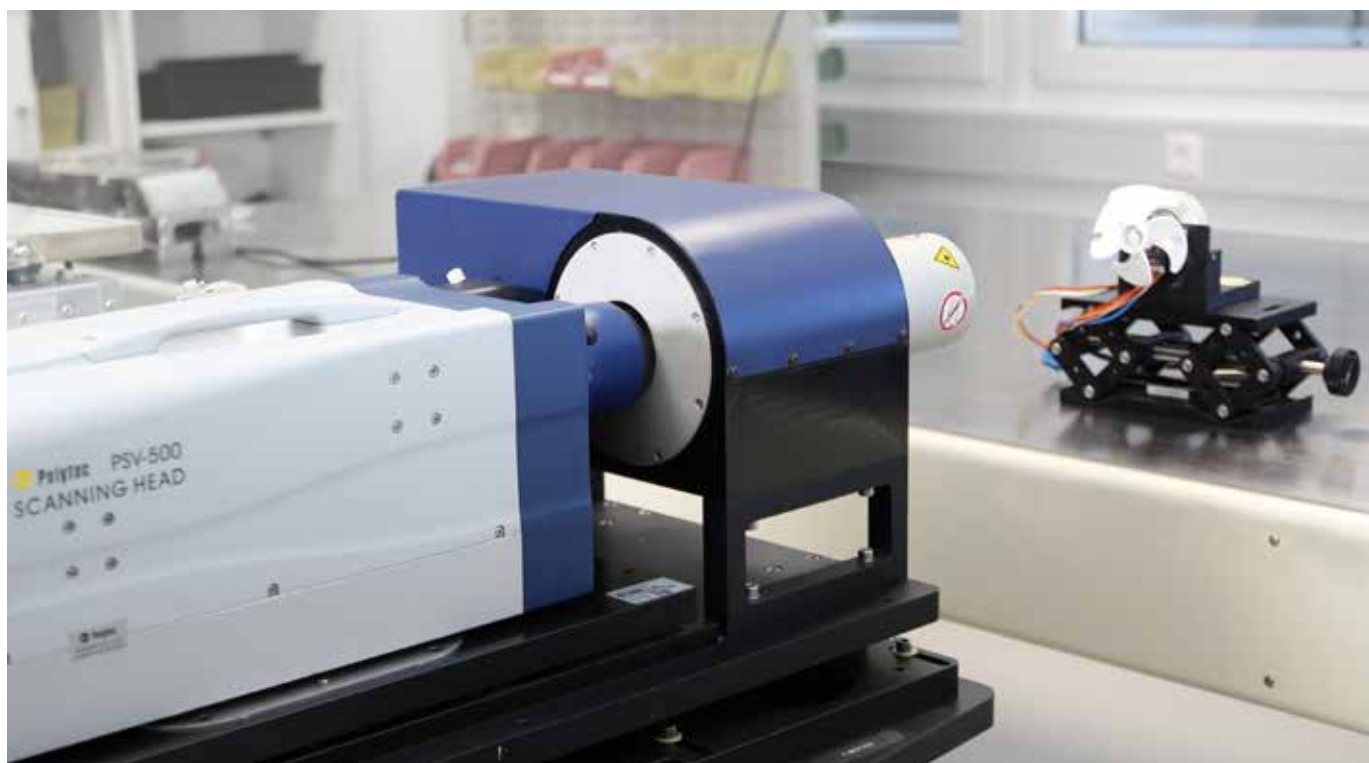
The PSV-A-440 光学ディロテータ 回転体の回転時の軸方向振動を測定
