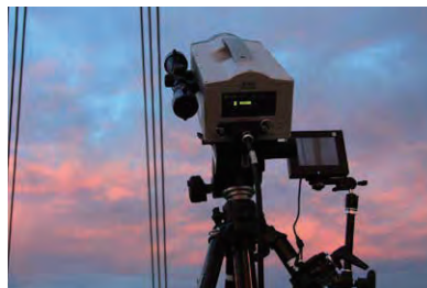
内蔵カメラの拡大映像で測定箇所を確認。正確な測定を実現
