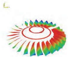
PSV-3Dによるタービンブレードの固有振動測定
