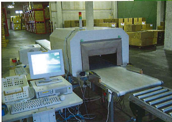
○製品に取り付けられたRFIDの情報を読み取るアンテナを組み込んだゲート
