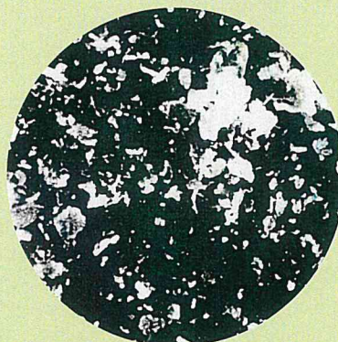
PECS に付着した微細金属粉 (×1000 電子顕微鏡写真)
